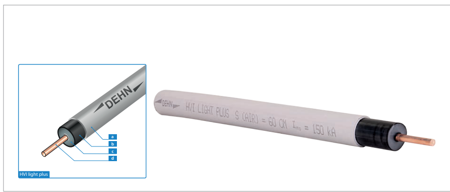
Rys. 2. Schemat budowy i wygląd przewodu HVI light plus: a) płaszcz zewnętrzny (Ø 21 mm/RAL 7004), b) płaszcz półprzewodzący (Ø 18 mm), c) warstwa izolacyjna, d) żyła miedziana jednodrutowa (16 mm 2 )
